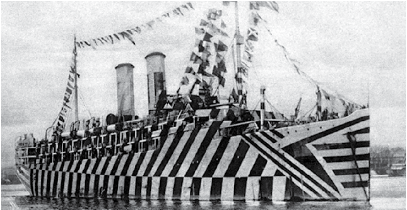
I. ve II. Dünya Harbi yıllarında radar gemilerde kullanılmaya başlayıncaya kadar tüm ticaret gemileri de denizaltıları şaşırtmak amacıyla alaca bulaca renklerle boyandılar.
